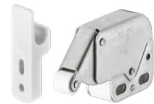
Federschnapp-Verschluss Mini-Latch Federschnapp-Verschluss in Weiß. Durch Druck auf die Türflä-che öffnet sich die Tür automa-tisch. Verschließen der Tür eben-falls durch leichten Druck gegen die Türfläche. Maße (B x H x T): 39 x 46 x 11 mm; Herst.-Nr.: 245.54.707 SB Art-Nr. 250/442 lose Art-Nr. 250/442-1
