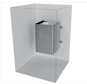
Vertikale Installation: 20 x 30 x 20 cm (B x H x T)
