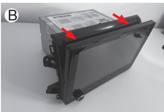
**B** Der Montagerahmen N-XFDUC8 wird direkt von hinten auf die Haupteinheit des Gerätes geschoben.
