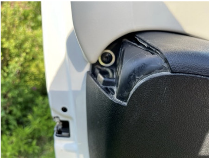
Nach dem Abnehmen der Kappe wird die Schraube sichtbar. Abbildung vom Vorgängermodell.
