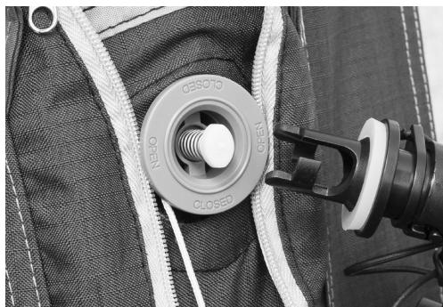
Setzen Sie am Pumpenschlauch den entsprechenden Adapter ein. Mit einer  $\frac{1}{4}$  Drehung arretieren Sie den Luftschlauch am Ventil und öffnen damit gleichzeitig das Ventil zum Befüllen. Beim Entfernen des Pumpenschlauches verschließt das Ventil automatisch. Setzen Sie anschließend die Schutzkappe auf das Ventil, um Verschmutzungen bzw. ein Entweichen von Luft zu vermeiden.
