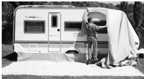
Das tragende Luftschlauchsystem ist bereits in der Zelthaut eingebaut und integriert. Befüllen Sie das Schlauchsystem über das Ventil mit der mitgelieferten Luftpumpe.
