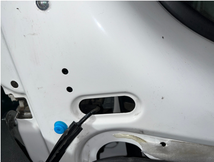
Übersicht: Den Stopfen an der Türfalz für den Zugang zur oberen Griffmutter abnehmen.
