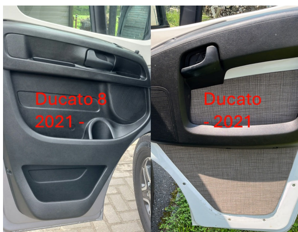
Links: neue Türverkleidung. Rechts: alte Türverkleidung.
