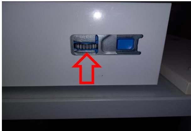
Die Feinjustierung in der Höhe erfolgt über die seitliche Verstellmöglichkeit in den Zargen.
