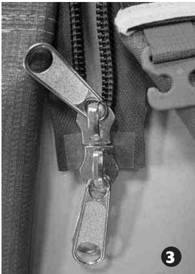
Den zweiten Schieber zum ersten Schieber platzieren
